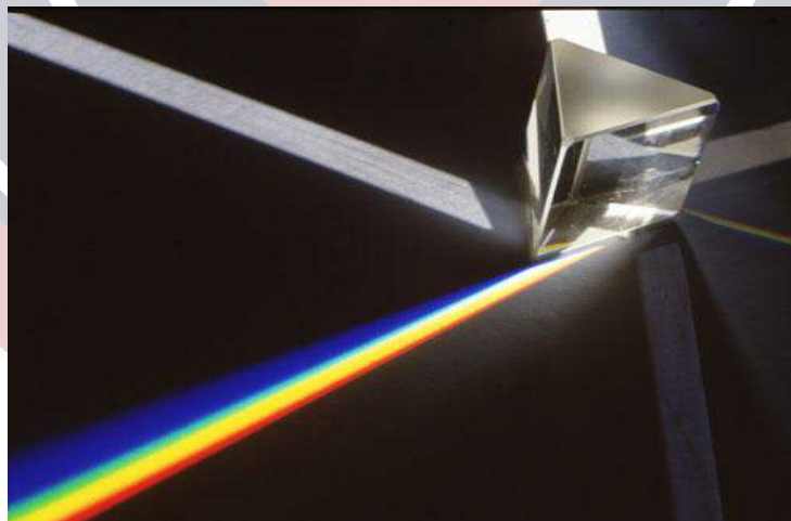
Doc 3. Photographie illustrant la décomposition de la lumière blanche d'une lampe à incandescence par un prisme.
